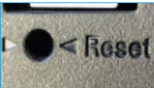
Drücken Sie mit einem spitzen Gegenstand 20 Sekunden in das Loch, bis der WPS/WLAN-Knopf „**ROT**“ leuchtet
